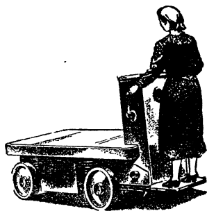
Электрическая вагонетка — электрокар — перевозит тяжёлые детали на заводе.
